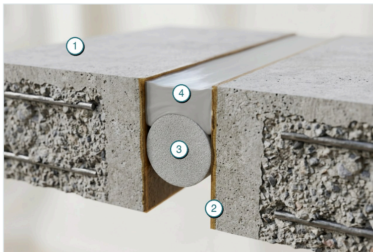
ДЕТАЙЛ 06-2 — Система за дилатационна фуга с РМ33
